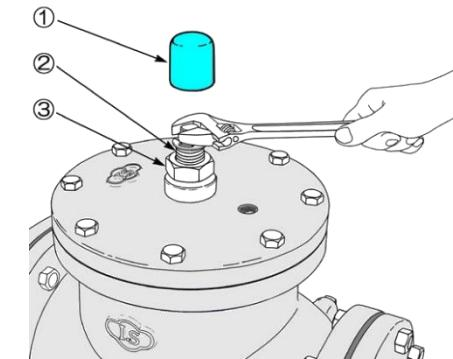
※④の作動テストで、なお止水しない場合は、流量調整スピンドルを徐々にねじ込んでください。（右回し）
